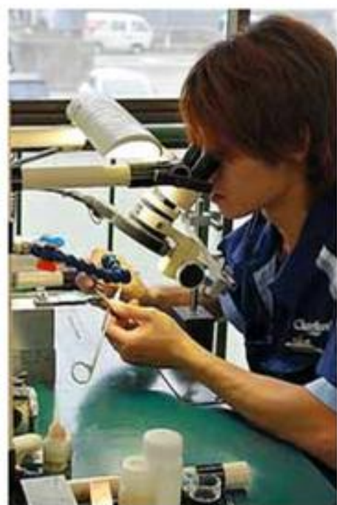
眼鏡枠製造大手シャルマンは特殊な手術用はさみなどで医療産業に参入。顕微鏡でチェックしながら刃先を最終仕上げする＝福井県鯖江市のシャルマン本社工場
